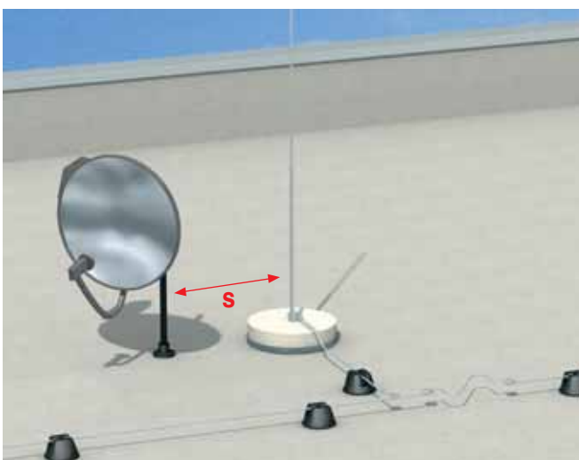
Правильно витримана відстань віддалення s між вловлюючим пристроєм та приладами SAT
